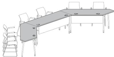
La surface de travail rectangulaire peut être reliée à une autre surface de travail rectangulaire ou à une surface de jonction « trapèze ».
