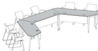
La surface de jonction « trapèze » peut être reliée à la surface de travail « trapèze » uniquement de façon permanente, et pour ce faire, elles doivent avoir la même profondeur.
