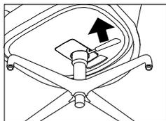
Utiliser le levier sous le siège, à gauche, pour en ajuster la hauteur. Tirer en appliquant un poids sur le siège pour le faire descendre, puis relâcher une fois à la hauteur désirée pour le bloquer en place. Tirer sur le levier sans appliquer de poids sur le siège pour faire monter ce dernier.
