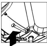
Utiliser le levier sous le siège, à droite, pour en ajuster la hauteur. Tirer en appliquant un poids sur le siège pour le faire descendre, puis relâcher une fois à la hauteur désirée pour le bloquer en place. Tirer sur le levier sans appliquer de poids sur le siège pour faire monter ce dernier.
