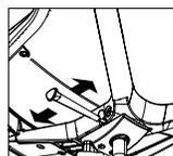
Utiliser le levier sous le siège, à droite, pour régler l'inclinaison du dossier : pousser vers l'avant pour bloquer le dossier et tirer vers l'arrière pour le débloquer.
