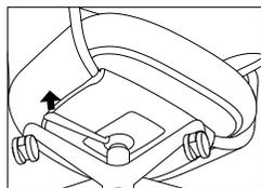
Utiliser le levier sous le siège, à droite, pour en ajuster la hauteur. Tirer en appliquant un poids sur le siège pour le faire descendre, puis relâcher une fois à la hauteur désirée pour le bloquer en place. Tirer sur le levier sans appliquer de poids sur le siège pour faire monter ce dernier.
