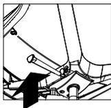
Pour abaisser le fauteuil, tirer la manette sous le siège, à droite, vers le haut en appliquant un poids sur le siège, puis relâcher la manette une fois à la hauteur désirée. Pour relever le fauteuil, tirer la manette vers le haut sans appliquer de poids sur le siège.
