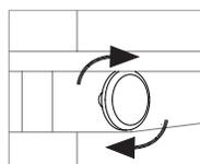
Pour lever ou baisser le repose-pied du tabouret pivotant, tourner la poignée dans le sens antihoraire pour débloquer le repose-pied et le régler à la hauteur désirée. Tourner la poignée dans le sens horaire pour le bloquer à nouveau.
