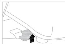
Pour régler la profondeur du siège, pousser le levier vers le bas et, simultanément, se soulever du siège en se glissant vers l'avant ou vers l'arrière. Relâcher le levier pour bloquer le siège dans la position désirée.
