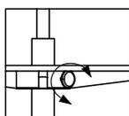
Pour relever ou abaisser le repose-pieds, tourner la poignée dans le sens antihoraire afin de le débloquer, puis l'ajuster à la hauteur désirée. Tourner la poignée dans le sens horaire pour le rebloquer.
