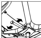
Utiliser la manette sous le siège, à droite, pour régler l'inclinaison du dossier : pousser vers l'avant pour bloquer le dossier et tirer vers l'arrière pour le débloquer.
