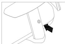
Pour régler la hauteur des appuie-bras, appuyer sur le bouton au milieu de chacun d'eux, puis lever ou baisser ces derniers à la hauteur souhaitée. Relâcher pour bloquer.
