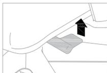
Pour incliner le dossier, tirer le levier vers le haut pour le débloquer. S'incliner à la position désirée et pousser le levier vers le bas pour bloquer le dossier.
