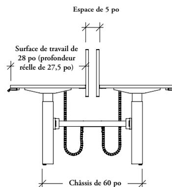
Lorsqu'un espace de 3 po est nécessaire pour installer un écran sur le châssis, les profondeurs de surface de travail et de châssis suivantes seront utilisées :
