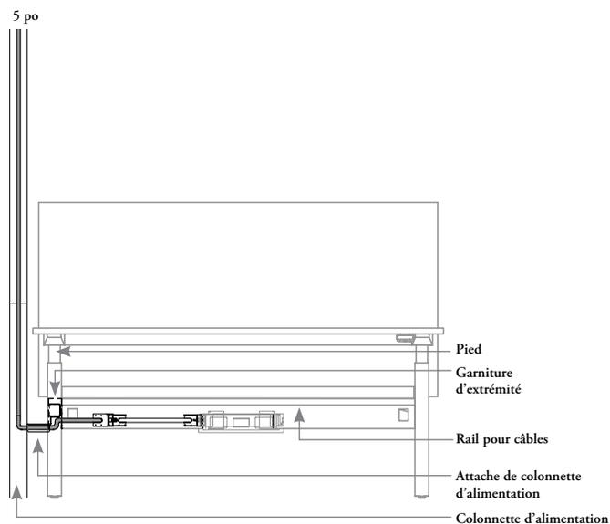
La colonnette d'alimentation se fixe au renfort du châssis afin d'acheminer le courant provenant du plafond. Installée à l'extrémité, elle dépassera de 5 po la surface de travail.
