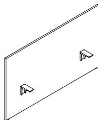
L'écran Navigate en placage formant un corridor pour châssis à un côté se fixe à la poutre pour accessoires du rail pour câbles Navigate (HNBFCN) pour créer une division physique et assurer l'intimité.
