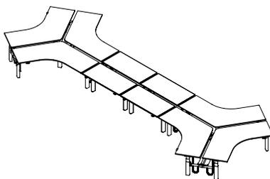
**2 châssis à 120° raccordés à 2 châssis rectangulaires**
