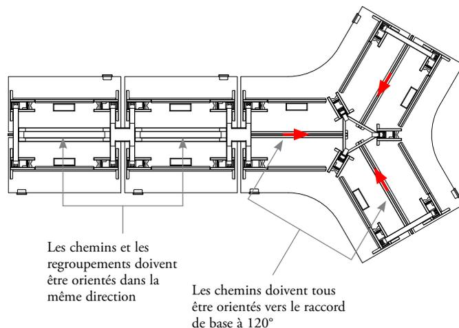
Les châssis à 120° sont conçus pour être utilisés avec des chemins doubles standard.
