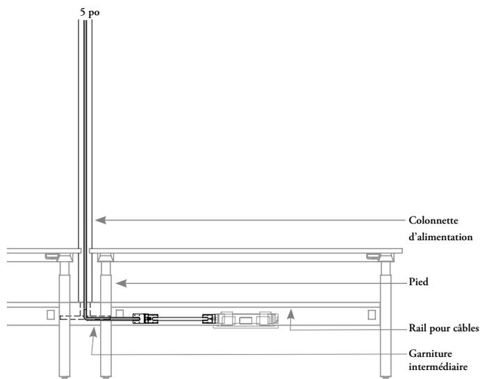
La colonnette d'alimentation se fixe au raccord de châssis afin d'acheminer le courant provenant du plafond. Si la colonnette est installée au centre, il faut commander la garniture intermédiaire avec l'option en conséquence. Les surfaces de travail doivent laisser un espace de 5 po de chaque côté de la colonnette d'alimentation.
