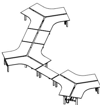
**3 châssis à 120° raccordés à un châssis rectangulaire et à un châssis à un côté**
