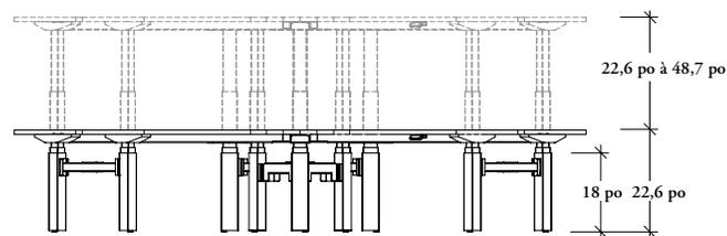
Mécanisme électrique à plage étendue – hauteur étendue
