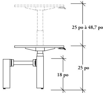
Mécanisme électrique à plage étendue – hauteur restreinte
