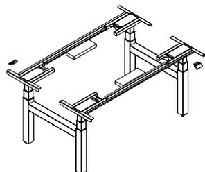
Le châssis double hiSpace s'utilise avec deux surfaces de travail pour châssis double afin de créer un regroupement de surfaces réglables en hauteur ou à hauteur fixe.
