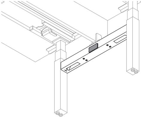
En l'absence d'un chemin de câbles central, certaines douilles restent exposées de chaque côté du châssis.
