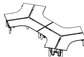
**2 châssis à 120° raccordés**
