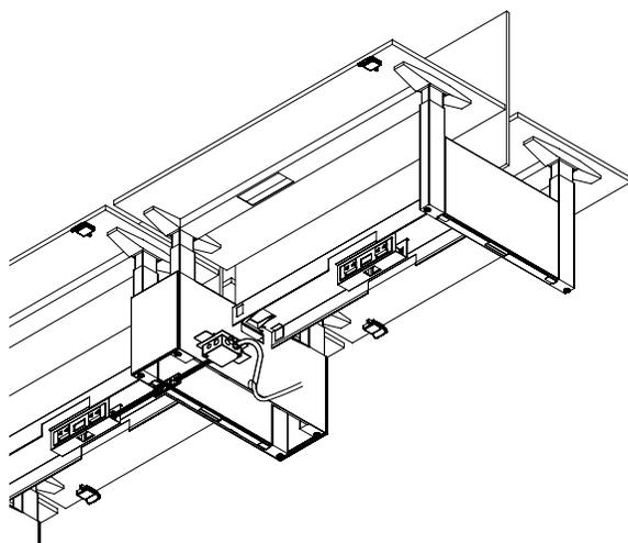
Si la prise au sol se trouve à l'extérieur du support intermédiaire, il faut commander un support intermédiaire avec l'option d'ensemble d'alimentation par la base.
