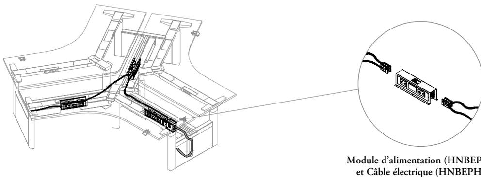
Module d'alimentation (HNBEPM) et Câble électrique (HNBEPH)
