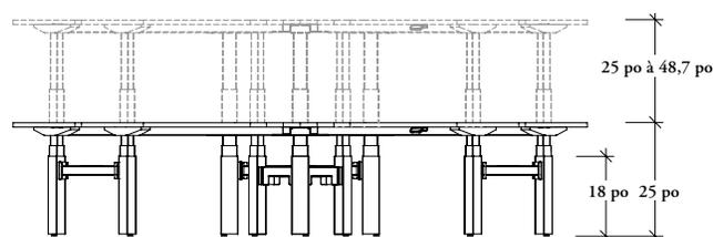
Mécanisme électrique à plage étendue – hauteur restreinte
