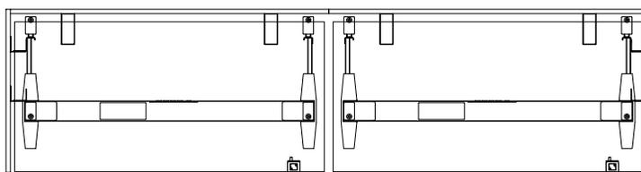
Les écrans d'extrémité pour châssis à un côté (HNBTS) peuvent être installés avec des écrans formant un corridor pour châssis à un côté (HNBLS) afin de créer un coin fermé.
