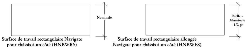
Il y a un espace de 2 po entre la surface de travail rectangulaire allongée Navigate pour châssis à un côté et l'écran formant un corridor.
