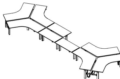
**2 châssis à 120° raccordés à un châssis rectangulaire et à un châssis à un côté**
