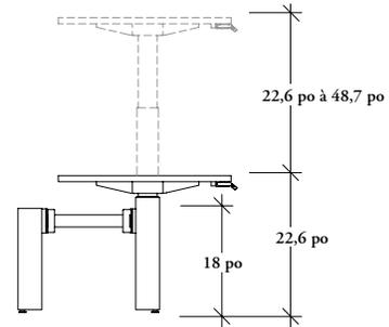
Mécanisme électrique à plage étendue – hauteur étendue
