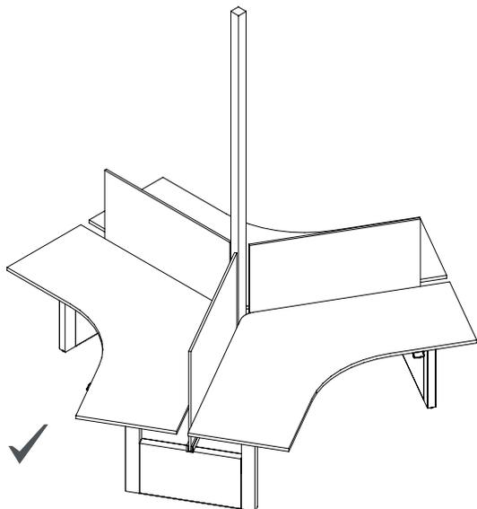
Les écrans fixes centraux pleine largeur **ne peuvent pas** être commandés avec un regroupement de surfaces à 120° Navigate lorsqu'il y a une colonnette d'alimentation.
