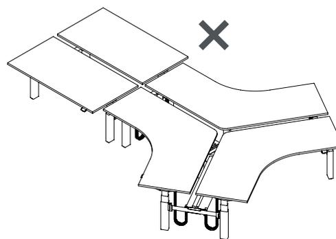
Les châssis à 120° Navigateur ne peuvent pas être raccordés à des châssis rectangulaires Navigateur de 72 po. Toutes les surfaces de travail doivent avoir la même profondeur.
