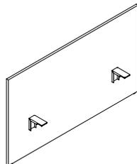
**HNBLBS** Ferrure de raccordement d'écran Navigate en placage pour châssis à un côté
