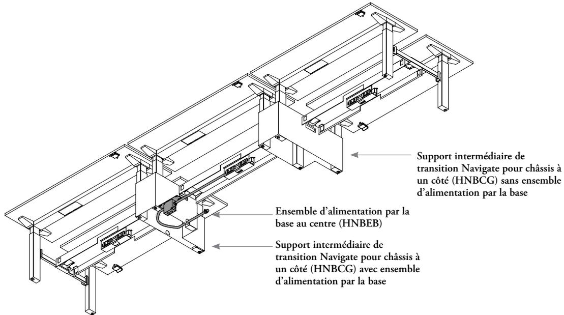
Lorsqu'il y a un support de transition, il faut commander un ensemble d'alimentation par la base au centre.
