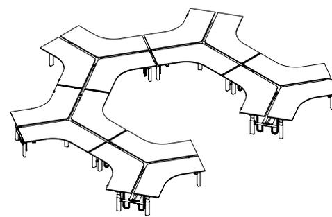
**5 châssis à 120° raccordés**
