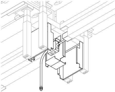
**Dispositif d'alimentation par la base avec colonne de montée des câbles – extrémité**
