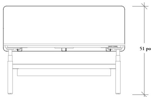
Dans les regroupements de surfaces doubles comportant un écran pour bord de bureau entre deux surfaces dos à dos, il y a un espace de 0,5 po pour le passage des câbles, ce qui laisse un dégagement de 1 po pour éviter les pincements.
