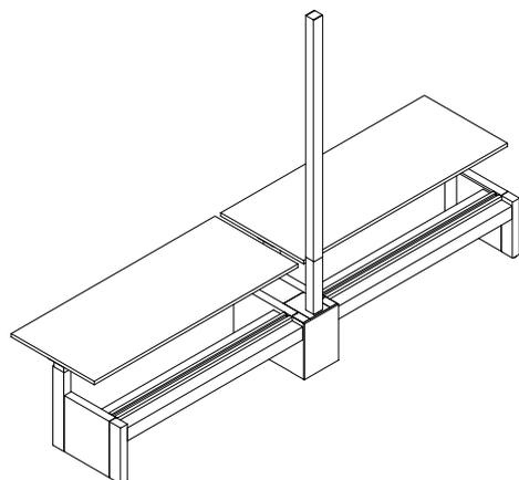
La colonnette d'alimentation au centre pour châssis à un côté se fixe au raccord de châssis (HNBFN). Elle ne peut pas être combinée à des surfaces de travail rectangulaires allongées.
