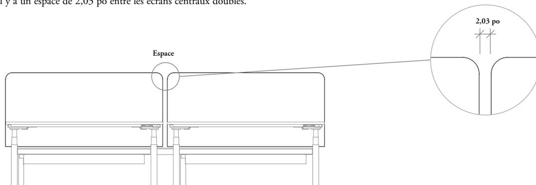
Il y a un espace de 3 po entre les surfaces de travail, ce qui assure un dégagement de 1 po de chaque côté des écrans (d'épaisseur maximale) afin d'éviter les pincements.
