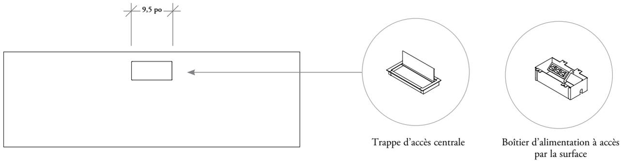
Lorsqu'on commande une découpe pour trappe d'accès centrale sur une surface de travail, il faut commander la trappe d'accès centrale hiSpace séparément.
