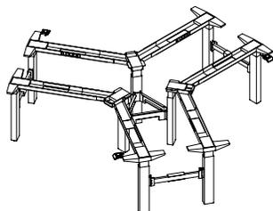
Le châssis Navigate à 120° s'utilise avec les surfaces de travail à 120° Navigate (HNBWNT) pour former un regroupement de surfaces réglables en hauteur Navigate constituant un poste de travail à 120°.
