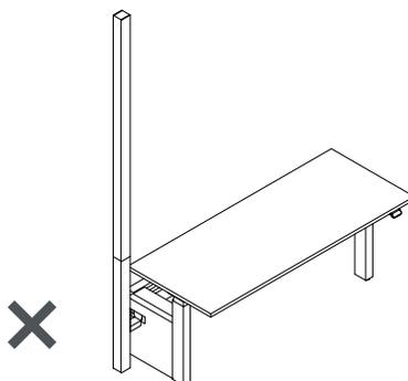
La colonnette d'alimentation ne peut pas être installée à l'extrémité s'il y a un support d'extrémité en métal ou en placage pour châssis à un côté.
