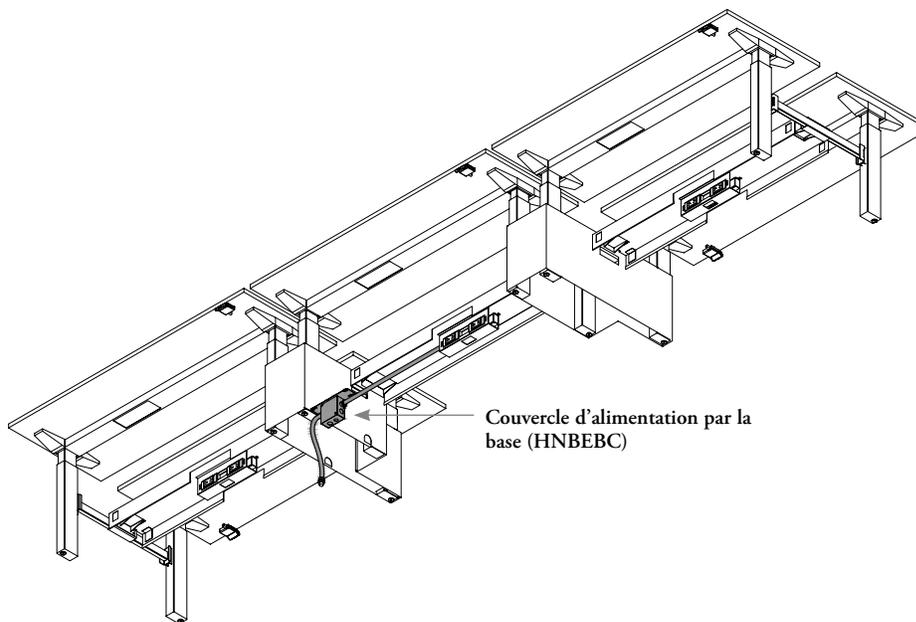
Si la prise au sol n'est pas directement sous le support intermédiaire de transition, il faut commander un couvercle d'alimentation par la base.
