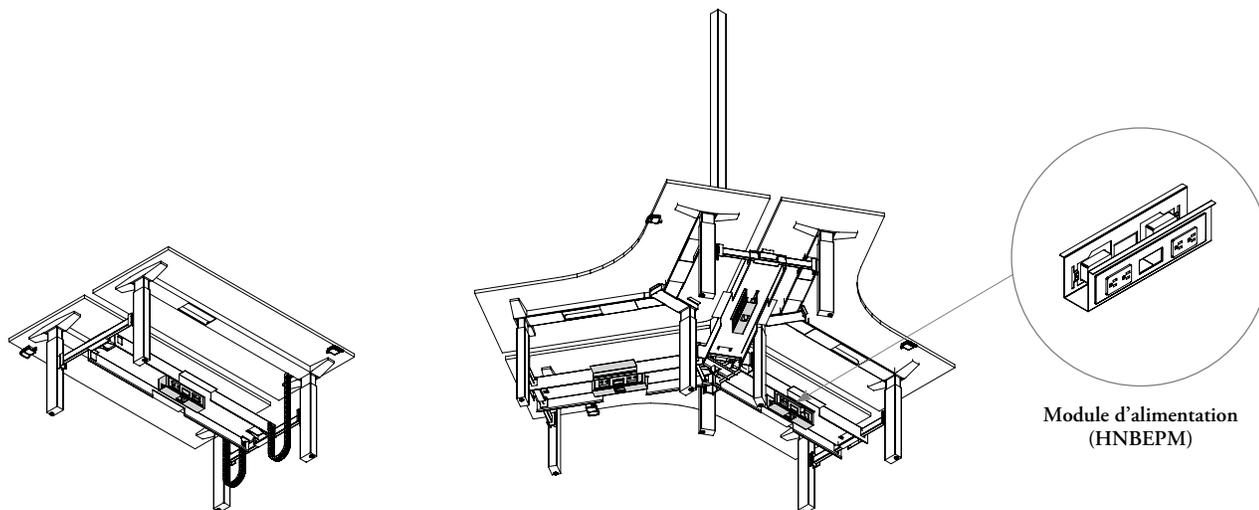
Module d'alimentation sur un châssis rectangulaire Navigate
