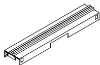
Le rail pour câbles Navigate dissimule et gère les systèmes électriques modulaires sélectionnés (commandés séparément), les câbles électriques ainsi que les câbles de données et de communication. Il comprend une poutre pour accessoires Interpret sur le dessus servant à installer les écrans fixes centraux.
