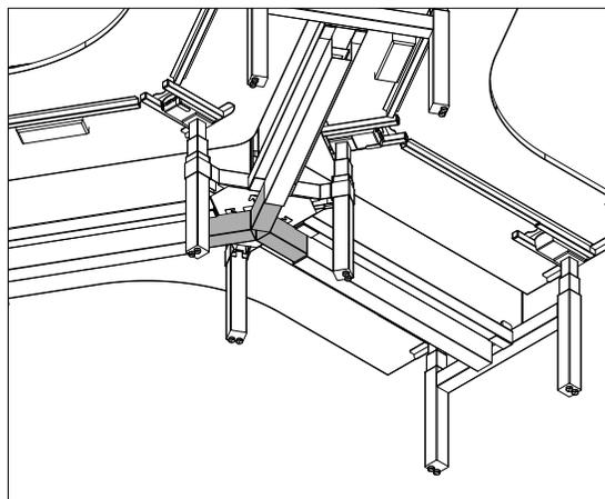
Lorsque l'acheminement par la colonne centrale n'est pas nécessaire, une passerelle pour câbles à 120° peut être commandée pour faciliter l'acheminement aux trois chemins de câbles centraux.
