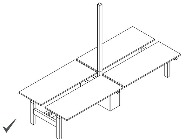
La colonnette d'alimentation peut être installée au centre avec un support intermédiaire Navigaté pour colonnette d'alimentation.
