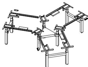
Le châssis à 120° hiSpace s'utilise avec la surface de travail à 120° avec coins droits (HWBWB) ou coins arrondis (HWBWBJT) pour créer un regroupement de surfaces réglables en hauteur ou à hauteur fixe.
