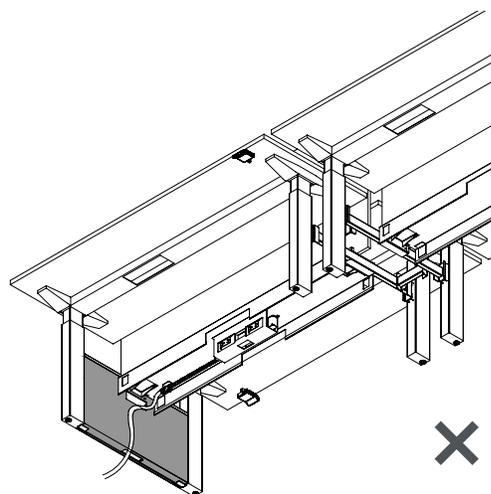
Si le courant doit être acheminé à l'extrémité d'un regroupement, il faut commander un couvercle d'alimentation par la base (HNBE).
