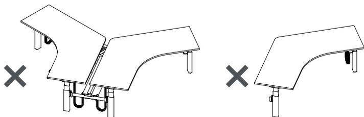
Les châssis à 120° Navigateur comprennent toujours trois bases. Les configurations pour un ou deux utilisateurs ne sont pas possibles.
