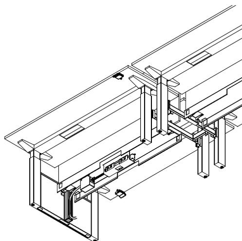
Il n'y a pas de découpe au bas d'un support d'extrémité pour acheminer un ensemble d'alimentation par la base d'une prise au sol jusqu'au rail pour câbles.
