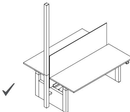
La colonnette d'alimentation peut seulement être installée à l'extrémité avec une garniture d'extrémité Navigate en métal.
