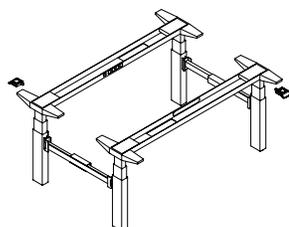
Le châssis Navigate s'utilise avec les surfaces de travail rectangulaires Navigate (HNBWRN) pour former un regroupement de surfaces réglables en hauteur constituant un poste de travail à deux côtés.
