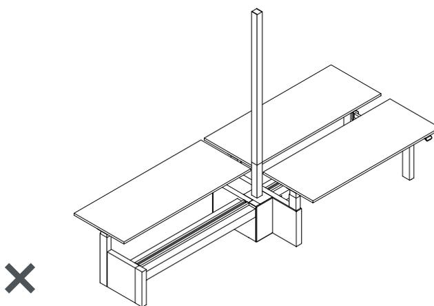
La colonnette d'alimentation ne peut pas être installée au centre avec un support intermédiaire de transition.
