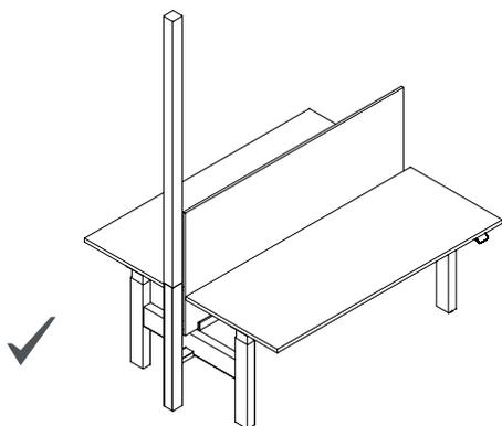
La colonnette d'alimentation **ne peut pas** être installée à l'extrémité s'il y a un support d'extrémité en métal ou en placage.
