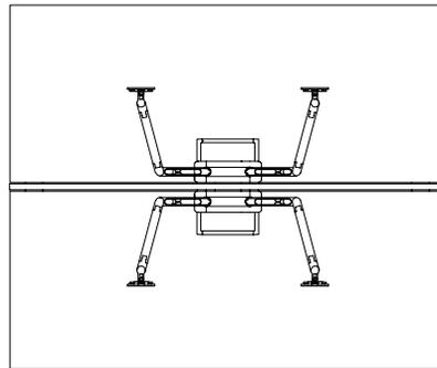
Avec un écran pour bord de bureau et une trappe d'accès centrale sur une surface de travail de 46 po, il n'y a pas assez d'espace pour un bras articulé Swerv double (YMSS22).
