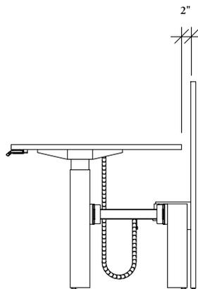
Écran formant un corridor pour châssis à un côté (HNBLS) et surface de travail rectangulaire allongée pour châssis à un côté (HNBWE)
