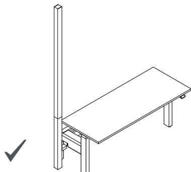
La colonnette d'alimentation peut seulement être installée à l'extrémité avec une garniture d'extrémité Navigaté en métal pour châssis à un côté.
