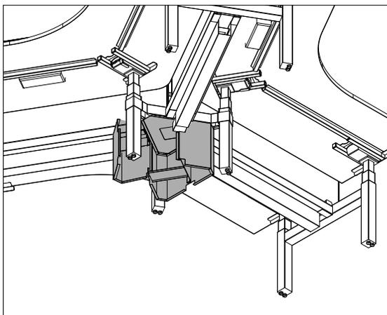
Trois types de dispositifs d'alimentation par la base conviennent à la colonne de montée des câbles à 120° intermédiaire :
