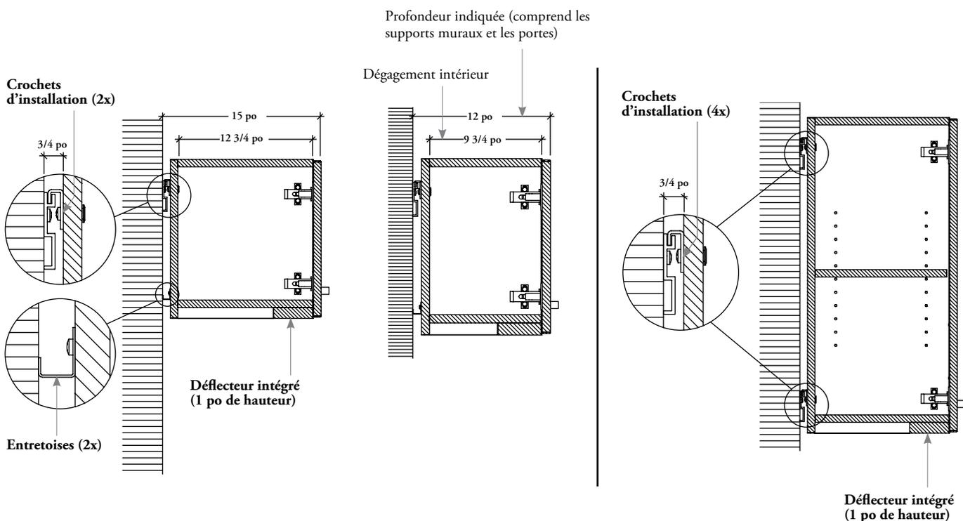
applications sur des cloisons altos (15 po à 36 po de hauteur)
