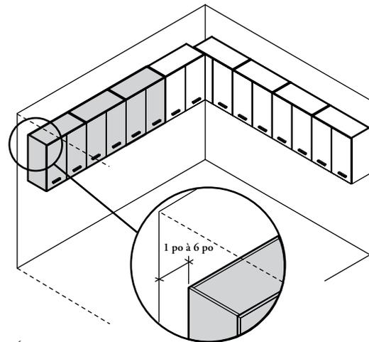
Étape 4 : Remplir le second mur d'armoires. Laisser un espace de 1 po à 6 po à l'extrémité pour que l'installateur puisse couper la jonction en fonction de la configuration du mur.
