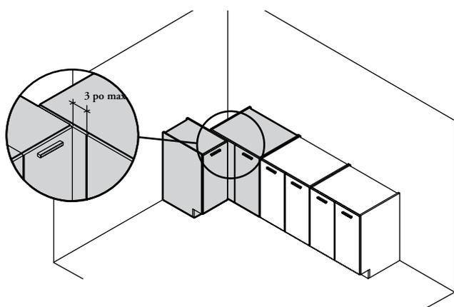
*Étape 3* : Finir la rangée avec une armoire d'angle (qui ne comprend qu'une porte) et commencer la nouvelle rangée en juxtaposant une armoire. Choisir les dimensions des armoires de manière à ne laisser voir qu'un maximum de 3 po de panneau fixe.
