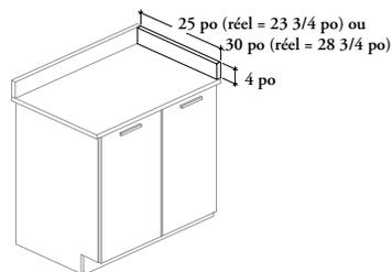
Ce produit ne s'utilise que sur le côté d'un dessus de comptoir et est joint à un dosseret.
