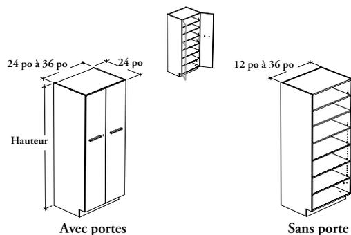
L'armoire de rangement standard a une grande capacité. Elle peut être facilement combinée à d'autres armoires et offrir ainsi différentes configurations.
