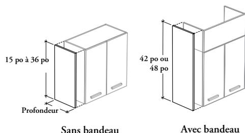
Cette composante en stratifié est utilisée lorsqu'une rangée d'armoires murales prend fin à plus de 6 po d'un mur. Ce panneau dissimule l'espace de 3/4 po entre l'armoire murale et le mur, de même que les trous percés sur place dans les côtés.
