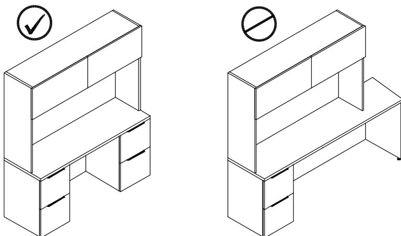
Les deux supports d'extrémité de la huche doivent reposer sur un rangement afin de supporter la charge.
