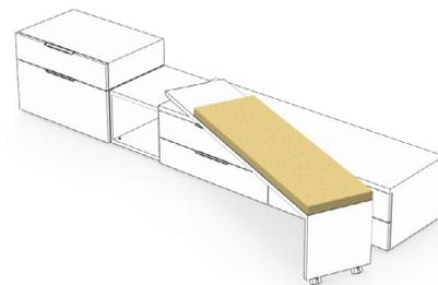
Lorsqu'un banc à pivot est utilisé à côté d'un autre rangement, les deux rangements doivent être de la même hauteur.
