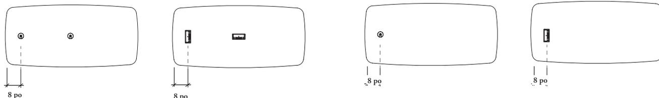
Sur les tables à hauteur fixe, l'option d'alimentation peut être au centre ou à l'extrémité de la surface de travail.
