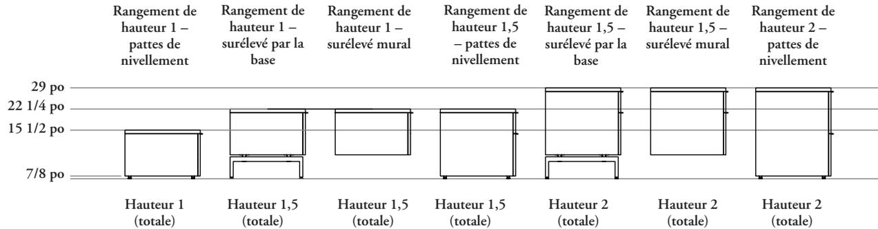
Base standard (pattes de nivellement) = La hauteur totale correspond à la hauteur du rangement.
