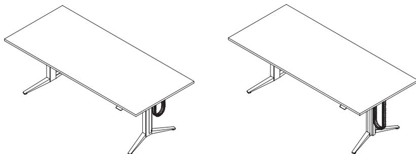
Chemin de câbles vertical intégrée, commandée et installée sur la face extérieure du pied du châssis
