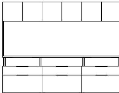
Lorsqu'un transfert de charge verticale est requis, les espaceurs doivent être placés au-dessus des supports du bahut.
